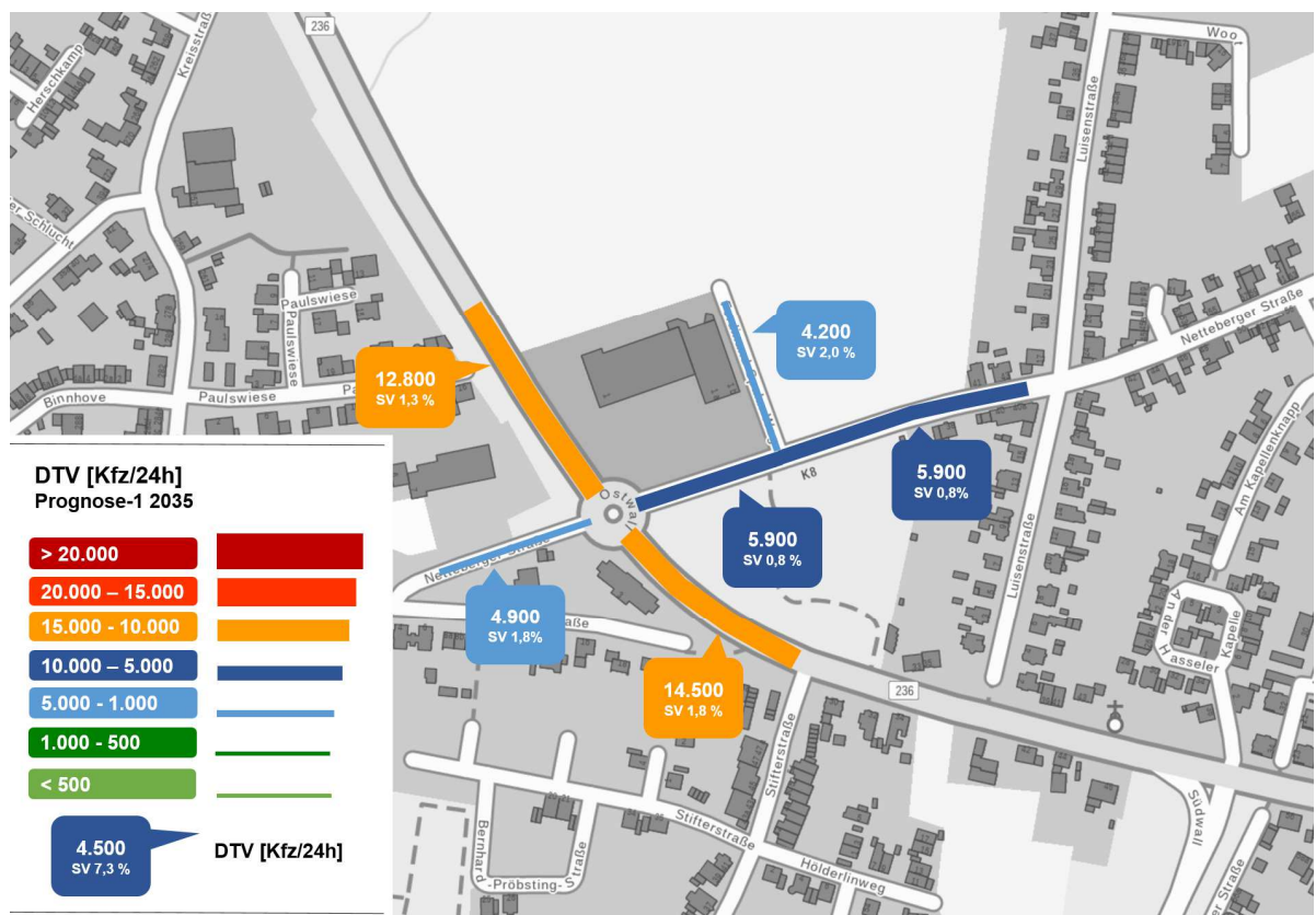
Abbildung 9: DTV-Werte im Untersuchungsgebiet, Prognose-1-Fall 2035 [Kfz/24h] (Grundlage [1])
